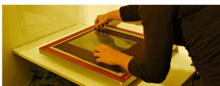
Legen Sie jetzt eine Klarglasplatte auf, so groß wie das Sieb. Die Platte soll die Folie auf das Sieb drücken.
